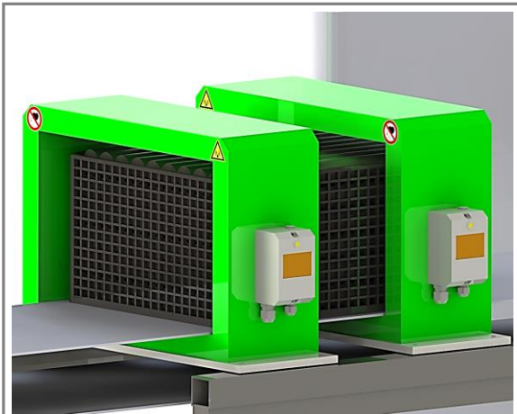
Bild: Spulenmodul in Helmholtz-Anordnung, horizontale Durchflutung der Bauteile, geeignet für Teile mit hohem Schlankheitsgrad liegend im Waschkorb.
