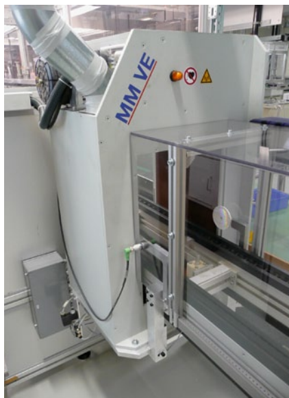
Bild 6: Beispielanwendung einer Entmagnetisiermaschine vor der Reinigungsanlage
