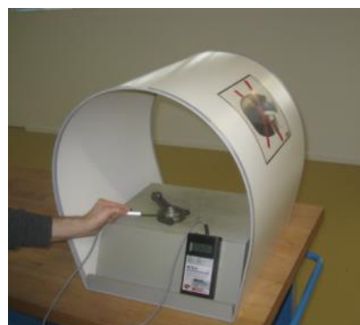
Chambre-zéro-Gauss Volume d'utilisation env. 250x250x250mm
