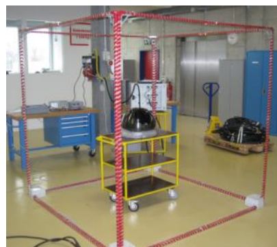
Chambre Helmholtz 3D Volume d'utilisation env. 1500x1500x1500mm
