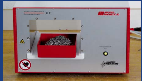
Die Teile werden innert wenigen Sekunden durch den Entmagnetisierungspuls entmagnetisiert.
