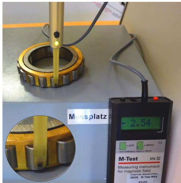
Bild: Messen von Wälzkörpern an Rollenkränzen mit Innenring. Messwert: 2.54 mT (= 20.2 A/cm)
