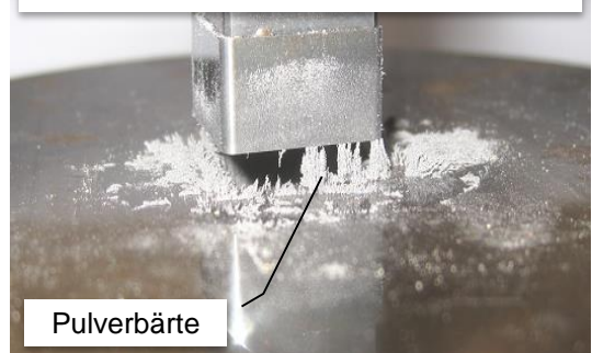
Matrize und Stempel, im Luftspalt über 50A/cm
